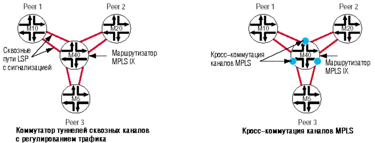
**Рисунок 7. Точка Интернет-доступа на базе MPLS**
