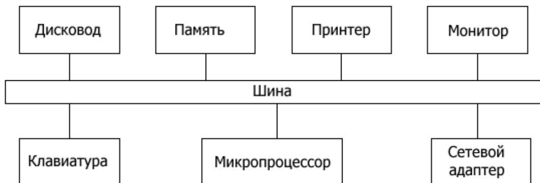
Рисунок 7. Взаимодействие микропроцессора с памятью и устройствами ввода-вывода
